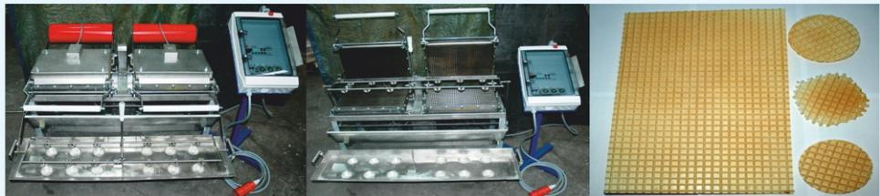
Автоматический дозатор для вафель типа лепешка общий для большинства противней.
