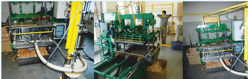
**Автоматическая вафельница для выпекания вафель с плоским дном типа стаканчик с упорядоченной подачей вафель из нижних неподвижных матриц, вертикальное устройство для декоративной гравировки**
